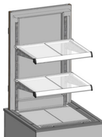
Figura 9: Colocação dos vidros nos suportes
