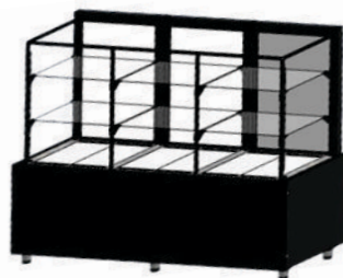
Figura 11: Colocação dos vidros nos suportes
