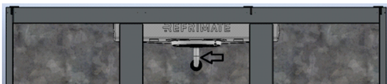
Figura 8: Detalhe da Capa do Forçador com o tubo conduíte para saída de água
