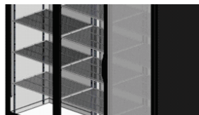
Figura 8: Colocação das grades (Arco virado para o fundo do gabinete)
