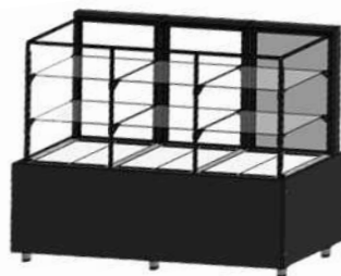
Figura 11: Colocação dos vidros nos suportes
