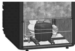
Figura 11: Acesso a unidade condensadora pela traseira
