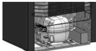
Figura 13: Acesso ao compressor pela traseira
