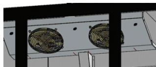
Figura 12: Imagem interna do evaporador e forçador Visa Cooler Extra Frio 3 portas
