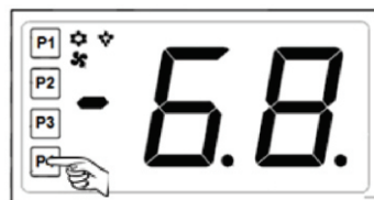
Figura 7: Modo econômico do display B05G
