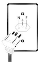
Figura 3: Plug modelo nacional com fio terra.
