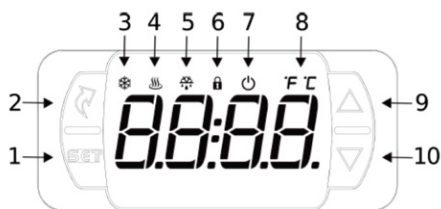
Figura 5: Controlador MT512E 2HP
