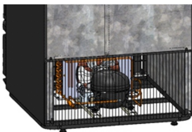
Figura 13: Acesso ao compressor pela traseira.
