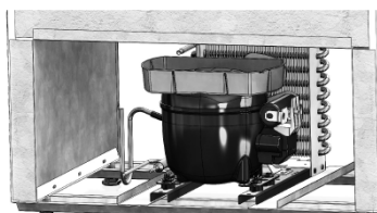
Figura 10: Compressor com bandeja coletora
