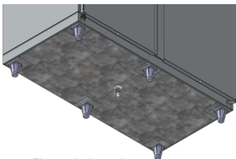
Figura 10: dreno de saída de água.
