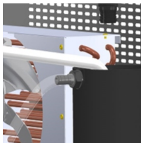
Figura 11: Válvula de drenagem para direcionar a água excedente.
