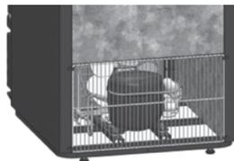
Figura 11: Acesso a unidade condensadora pela traseira
