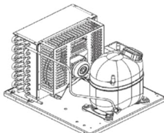
Figura 14: Unidade Condensadora
