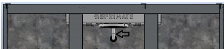
Figura 8: Detalhe da Capa do Forçador com o tubo condute para saída de água
