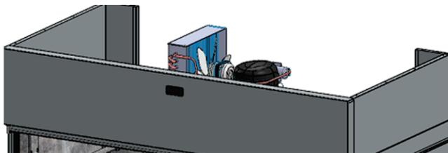
Figura 14: Unidade Condensadora
