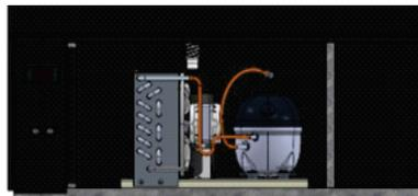
Figura 16: Unidade Condensadora
