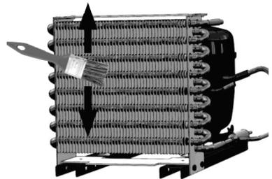
Figura 20: Limpando o condensador
