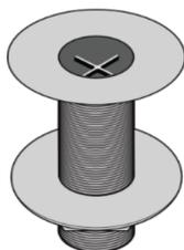
Figura 10: Detalhe do dreno de saída para água
