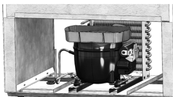
Figura 8: Compressor com bandeja coletora
