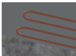
Figura 13: Serpentina interna da bacia.
