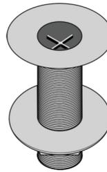
Figura 6: Detalhe do dreno de saída para água
