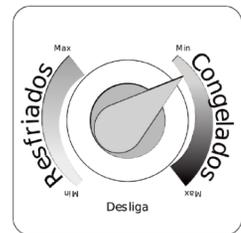
Figura 5: controlador mecânico
