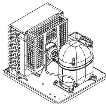
Figura 8: Figura Condensadora
