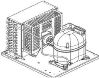
Figura 12: Unidade Condensadora
