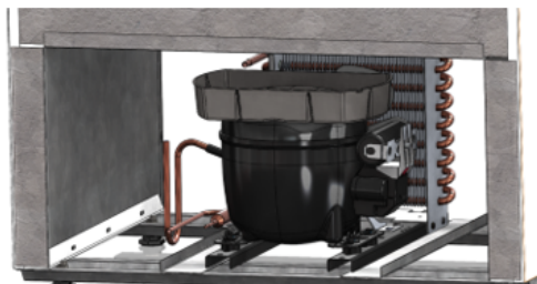
Figura 7: Compressor com bandeja coletora.
