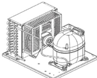
Figura 14: Unidade Condensadora
