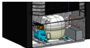
Figura 13: Acesso ao compressor pela traseira
