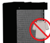
Figura 13: Não pendure objetos no condensador.
