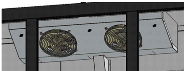
Figura 12: Imagem interna do evaporador e forçador Visa Cooler Extra Frio 3 portas
