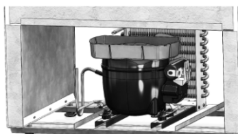
Figura 8: Compressor com bandeja coletora
