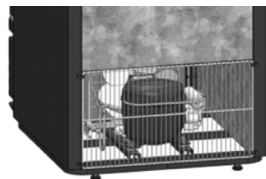
Figura 12: Acesso a unidade condensadora pela traseira
