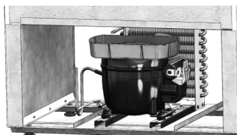
Figura 8: Compressor com bandeja coletora
