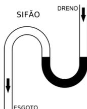
Figura 9: Sifão para evitar o mau cheiro da rede de esgoto.
