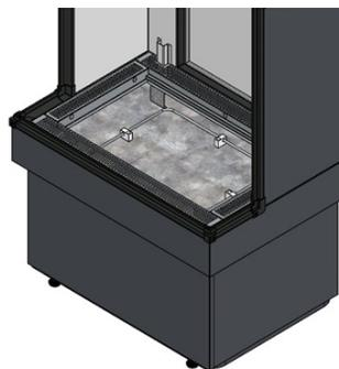
Figura 15: Resistências no interior do balcão
