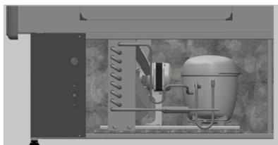
Figura 14: Unidade Condensadora
