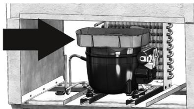
Figura 7: Compressor com bandeja coletora
