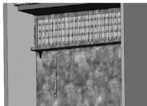
Figura 11: Evaporador Aletado
