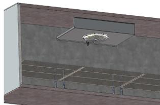
Figura 12: Evaporador com ar forçado
