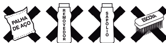
Figura 13: Produtos que danificam o equipamento
